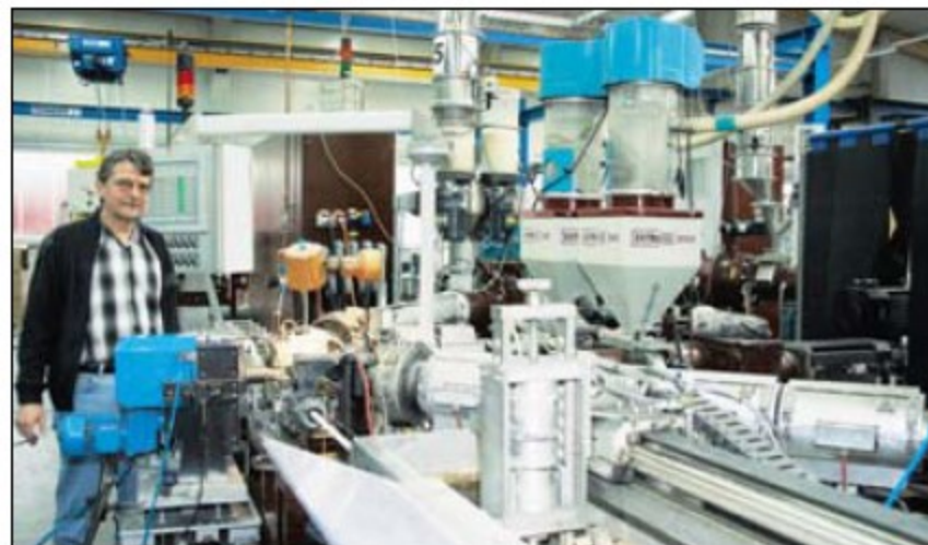
Eine Eigenentwicklung ist diese Maschine, an der die Mehrschicht-Verbundrohre hergestellt werden. Bilder: Jotzeit
